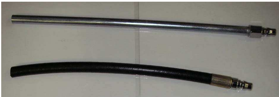
Рис. 3 Переходники для подключения аппарата к АКП .
