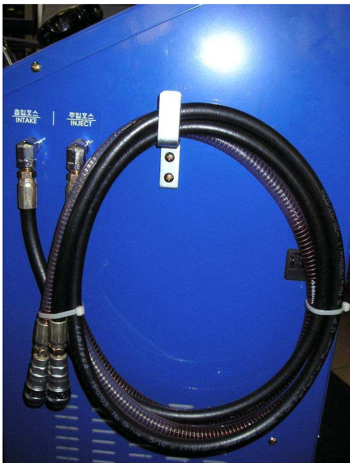
Рис. 4 Шланги присоединения Apparata к АКП
