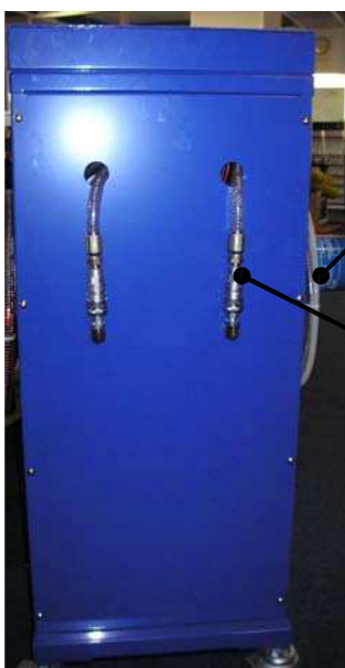
Рис. 9. Шланг для откачки жидкости через щуп.
