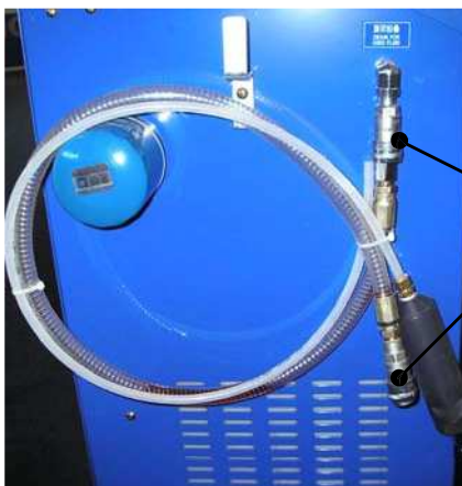
Рис.10 Шланг для слива отработанной жидкости из аппарата
