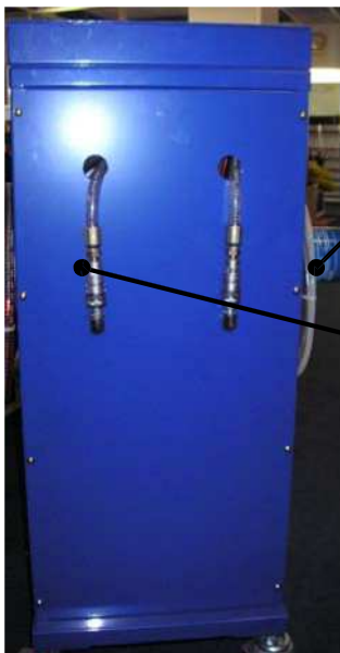
Рис. 7. Шланг для откачки из внешнего резервуара
